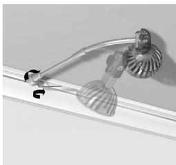
**3) Le placement des luminaires :** les tiges munies du spot lumineux se positionnent dans la rainure supérieure (conduit séparé) et se bloquent à la position voulue en effectuant un simple quart de tour. Le serrage d'une vis et une bague de réglage sécurisent le système. Le rail d'alimentation est dissimulé dans le profilé pour un esthétisme épuré. Nouveau : les lampes sont également disponibles en leds.
