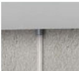
**4) Le placement des câbles acier ou des fils perlon.** La nouvelle tête twister se place dans la rainure inférieure (conduit séparé) et se bloque en effectuant un quart de tour. Avec sa nouvelle forme, la tête disparaît sous le profilé. Capacité du rail en poids porté : 50 kg / ml.
